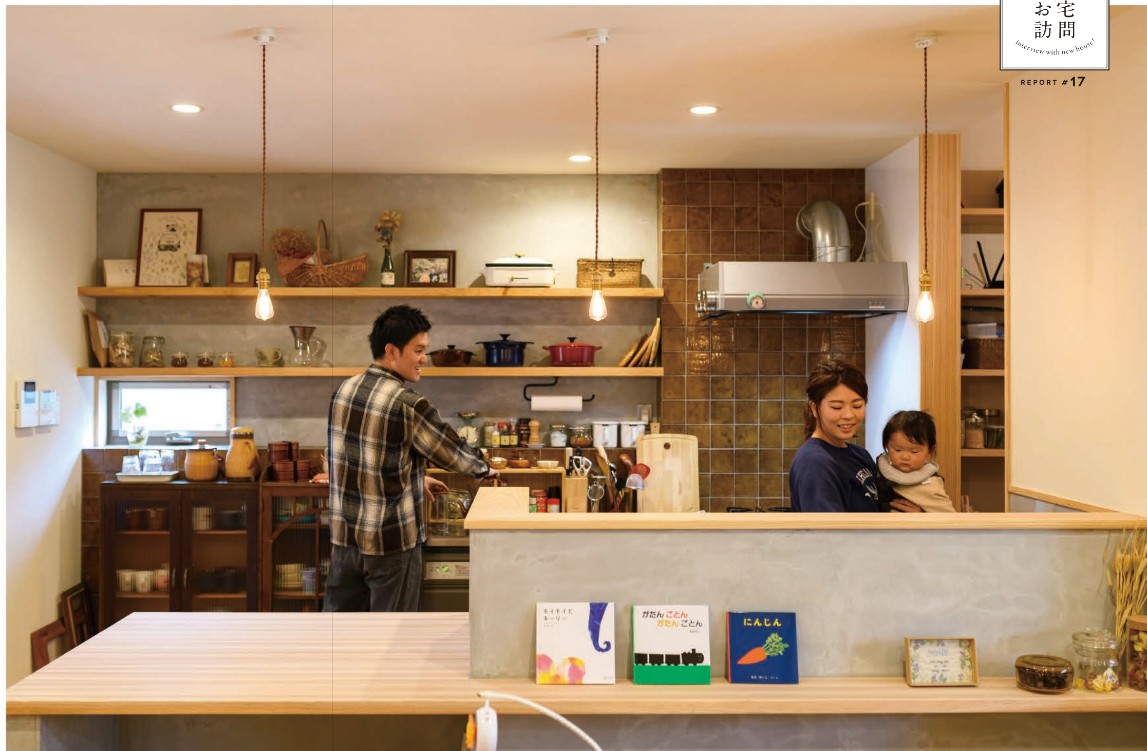
シンクと作業台に段差を設けたカウンターキッチン。作業台はダイニングテーブルと同じ高さに合わせ、ひと続きにすることができる
